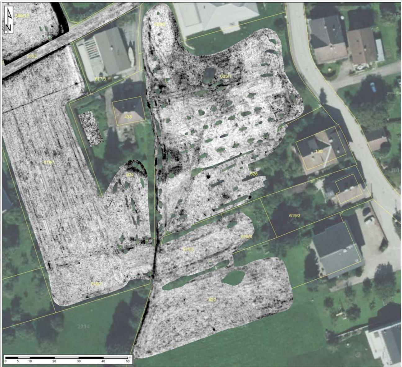
Abb. 10: Amplitudenflächenplan des Tiefenbereichs von 0 – 0,4 m der Bodenradarmessung im Bereich der Villa.
