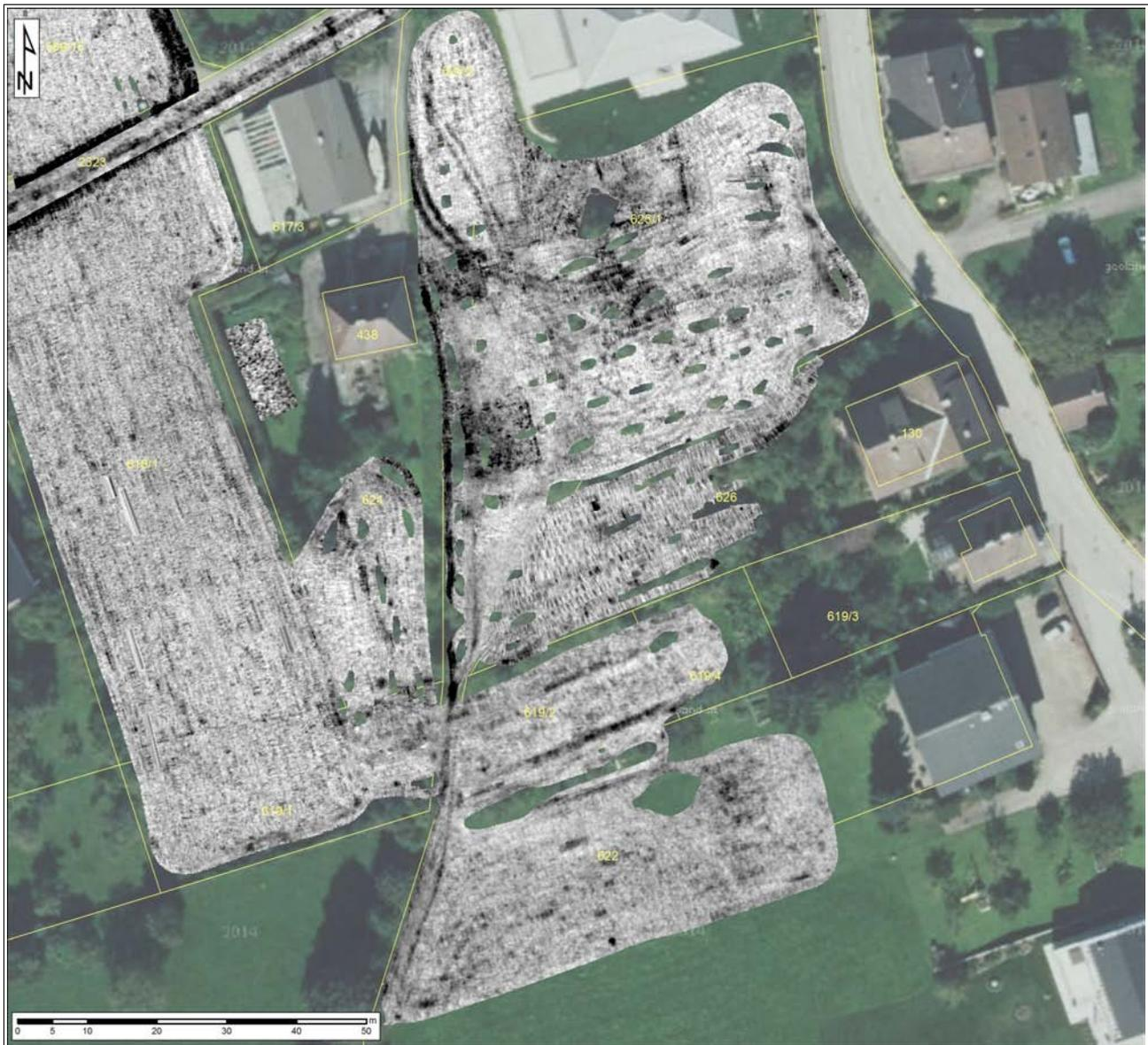
Abb. 14: Amplitudenflächenplan des Tiefenbereichs von 0,85 – 1,5 m der Bodenradarmessung im Bereich der Villa.
