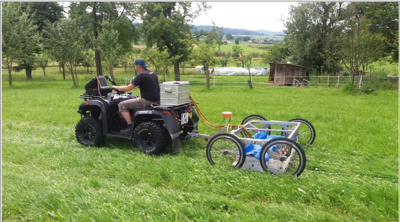
Abb. 7: Einsatz des motorisiertes Sensors & Software PulsEKKO Pro Multichannel® Bodenradarmessgerätes in Weyregg.
