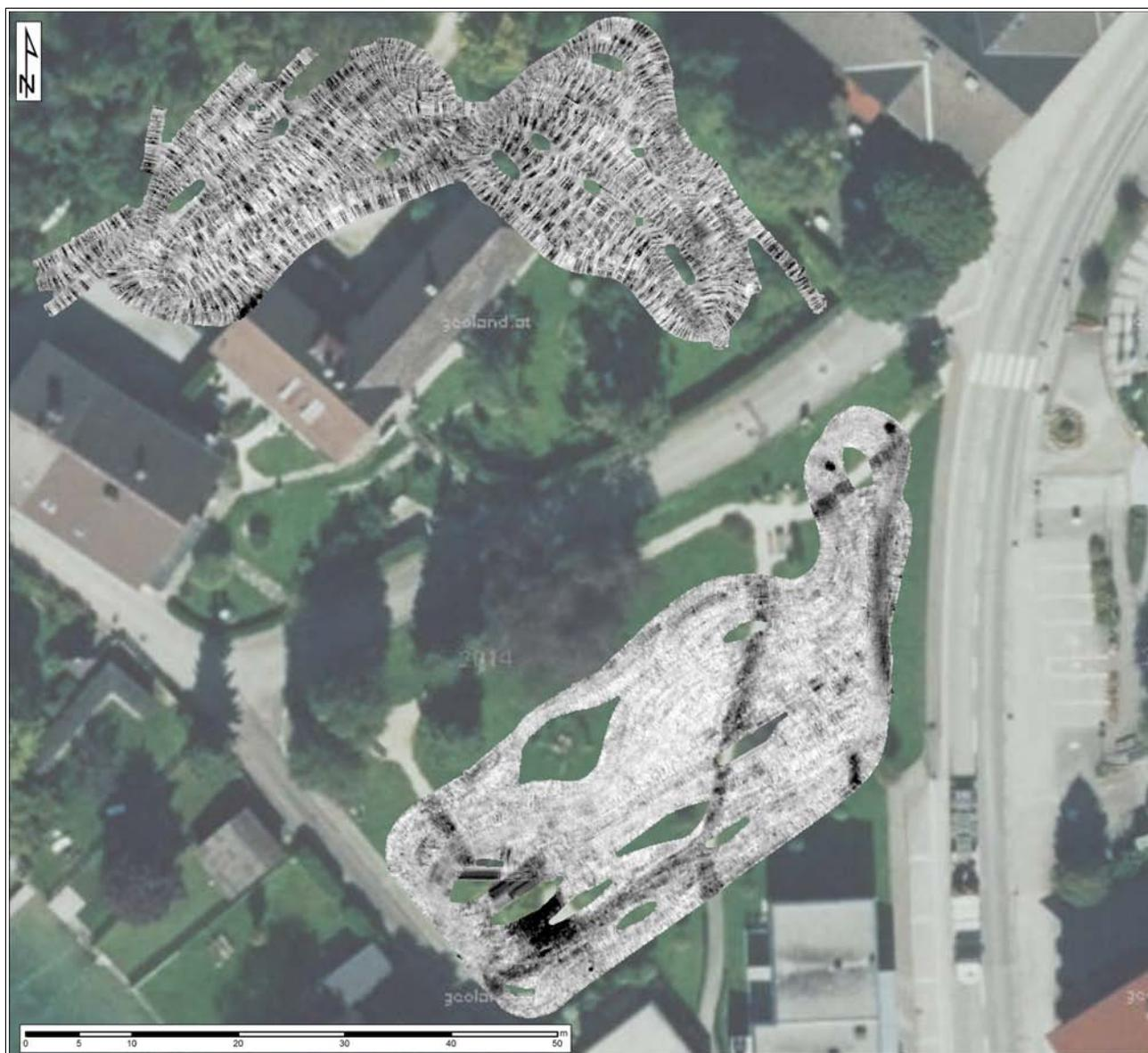
Abb. 32: Amplitudenflächenplan des Tiefenbereichs von 1,5 – 2 m der Bodenradarmessung im Bereich des möglichen ehemaligen Schlosses.
