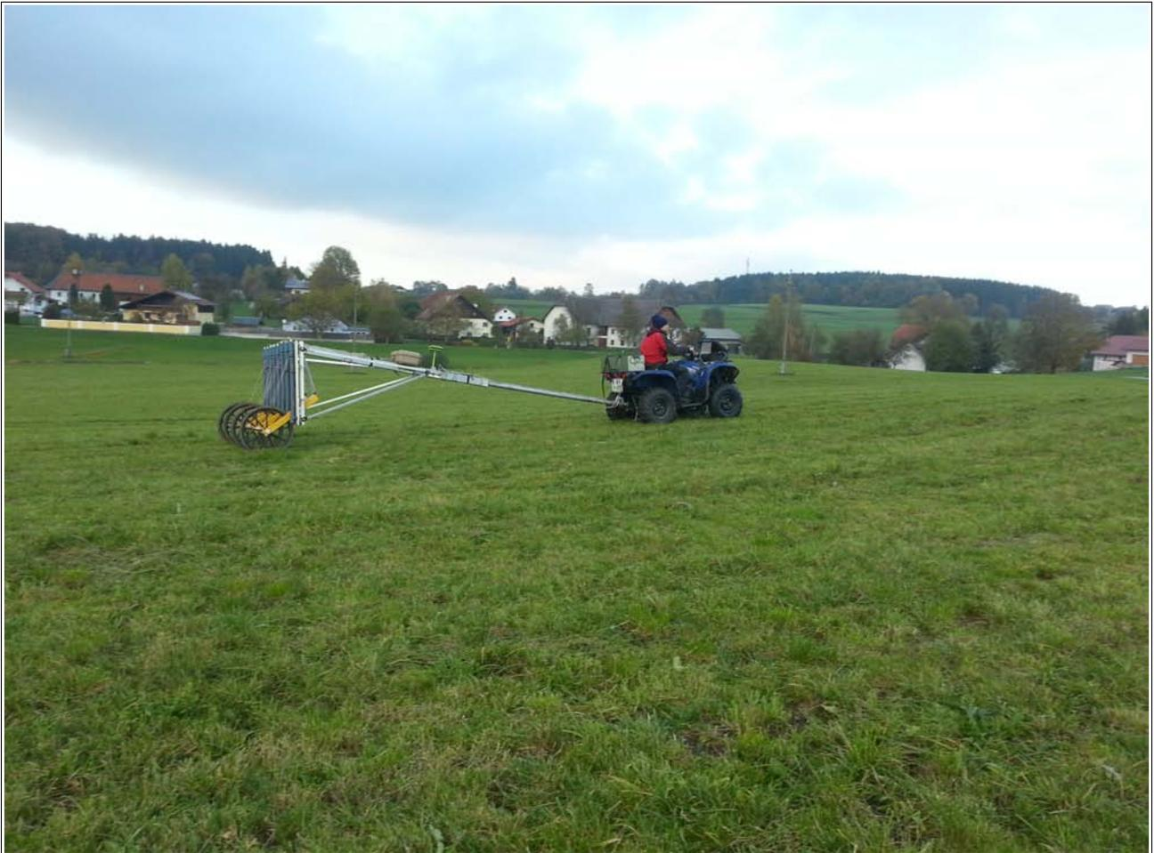
Abb. 5: Einsatz des Förster FEREX Fluxgate 8-Sonden Magnetometersystems in Litzlberg 2015.
