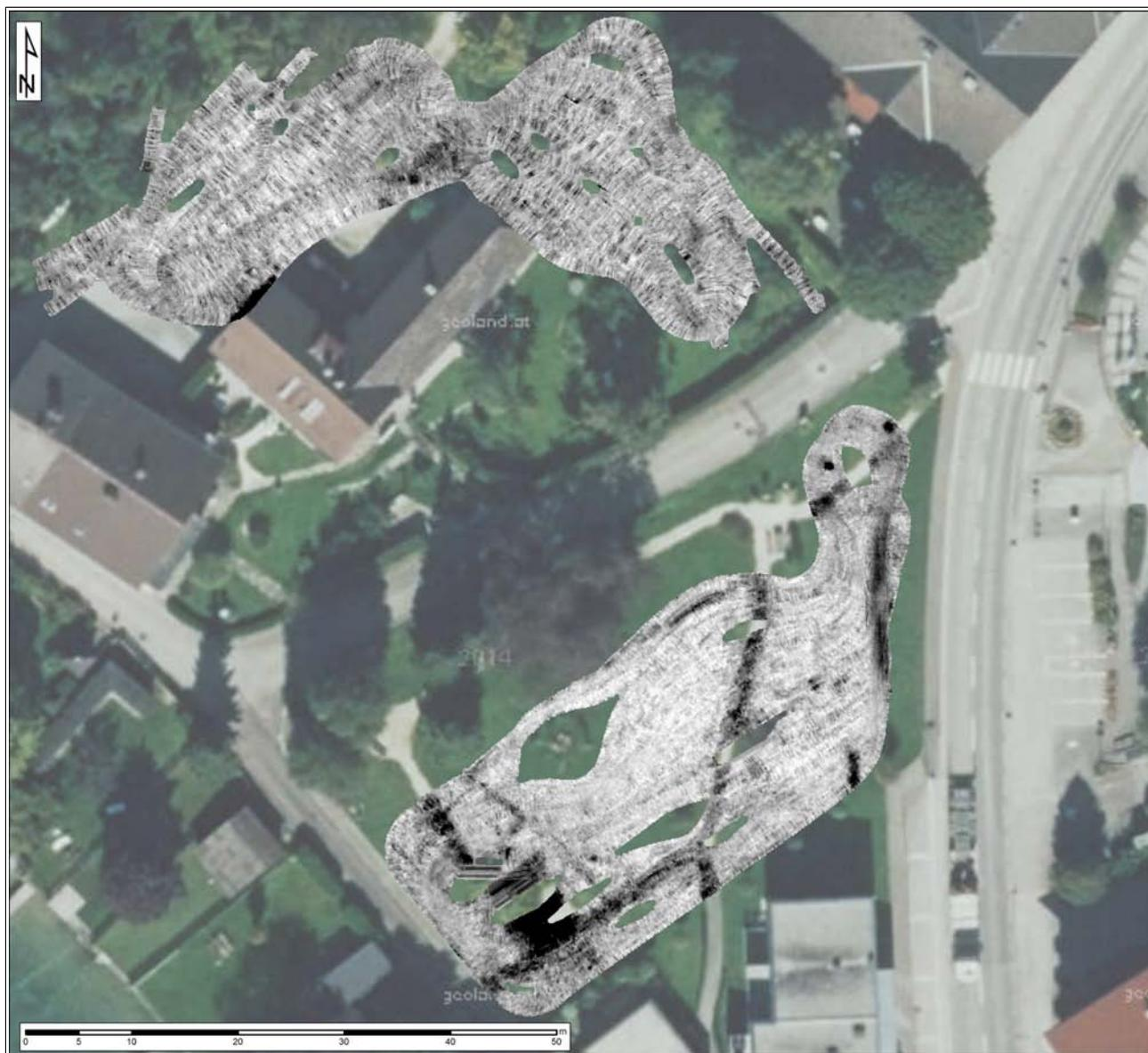
Abb. 30: Amplitudenflächenplan des Tiefenbereichs von 1 – 1,5 m der Bodenradarmessung im Bereich des möglichen ehemaligen Schlosses.
