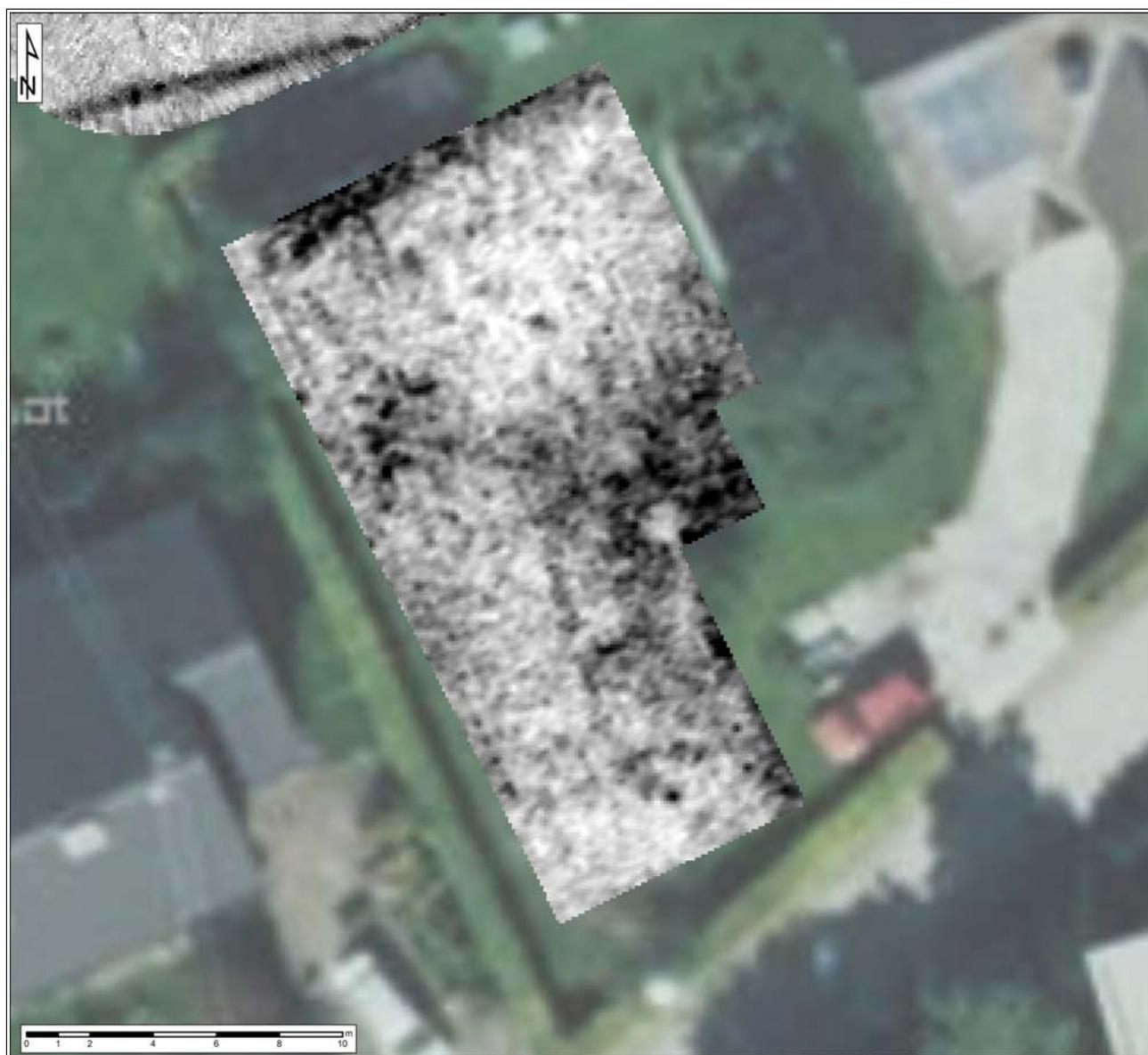
Abb. 16: Amplitudenflächenplan des Tiefenbereichs von 0,5 – 1 m der händischen Bodenradarmessung nördlich der Villa.
