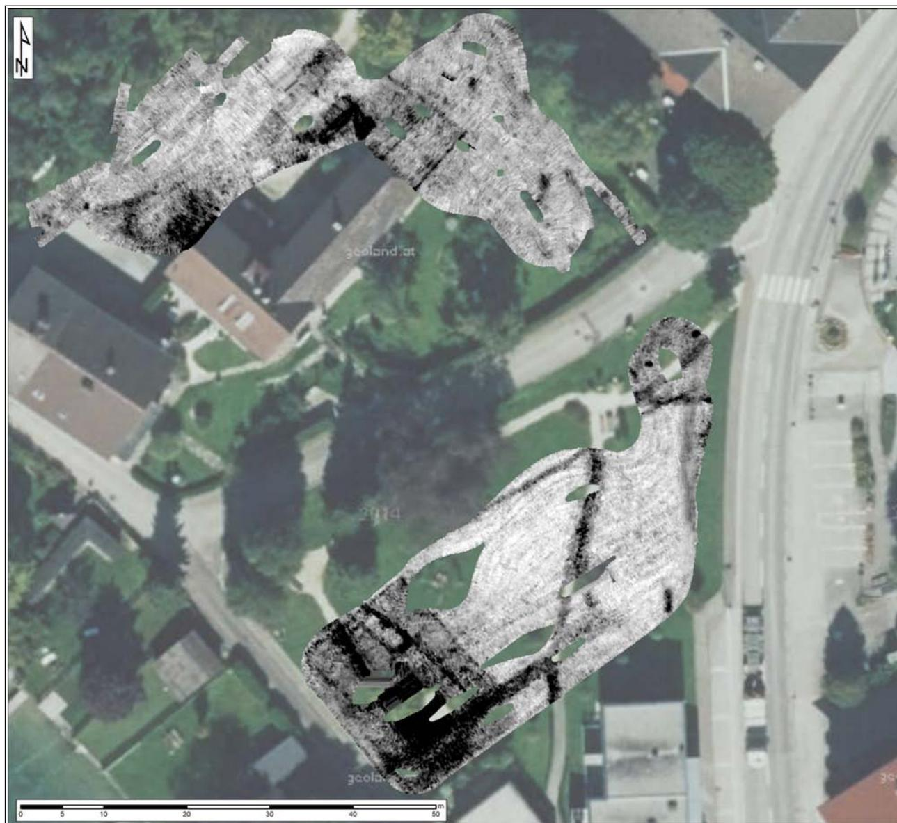
Abb. 28: Amplitudenflächenplan des Tiefenbereichs von 0,5 – 1 m der Bodenradarmessung im Bereich des möglichen ehemaligen Schlosses.
