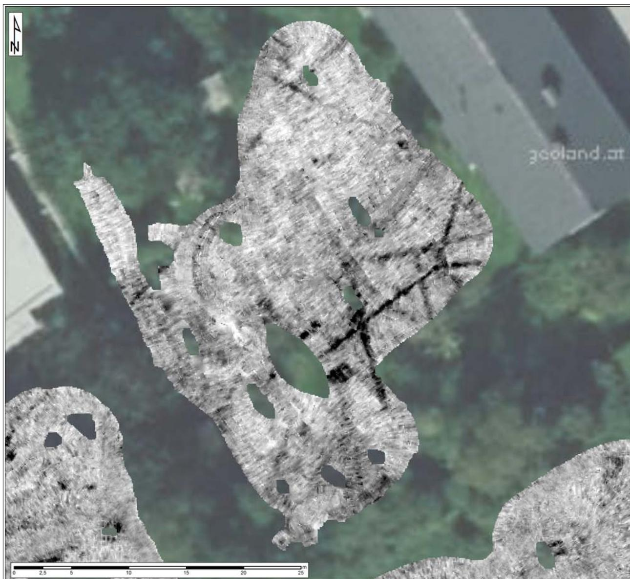
Abb. 18: Amplitudenflächenplan des Tiefenbereichs von 0,5 – 1 m der Bodenradarmessung im Garten der Pfarre.
