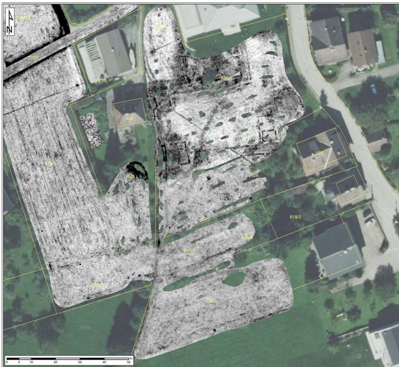
Abb. 12: Amplitudenflächenplan des Tiefenbereichs von 0,4 – 0,85 m der Bodenradarmessung im Bereich der Villa.
