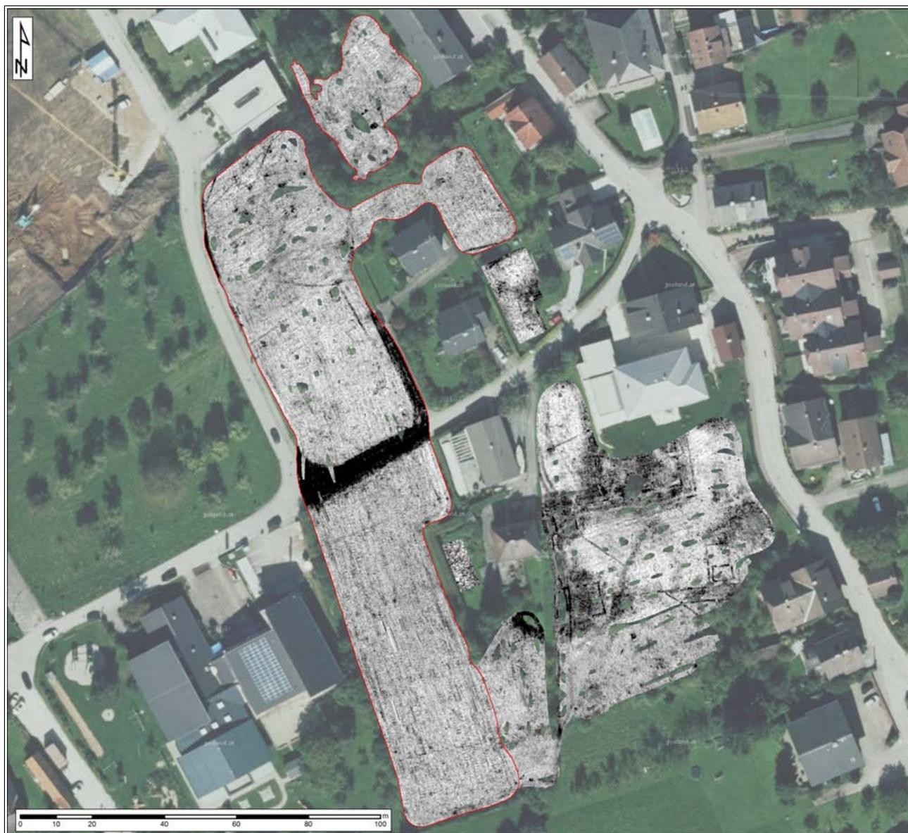
Abb. 22: Amplitudenflächenplan (rot umrandet) des Tiefenbereichs von 0,8 – 1,15 m der Bodenradarmessung westlich der Villa.
